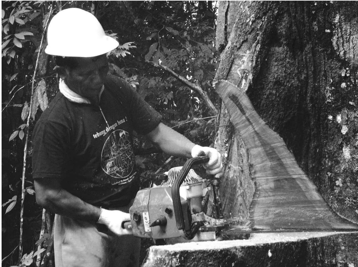
Penentuan arah rebah harus diterapkan dengan baik dalam teknik RIL (Foto oleh Hari Priyadi)
